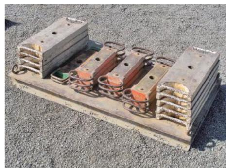
5kg、10kg、30kg、50kgと、4種類の板状の重量物を組み合わせる。
